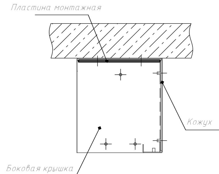
После монтажа корпуса, сегменты выставляются по уровню, для выравнивания используются подкладные пластинки и регулировочные винты.
