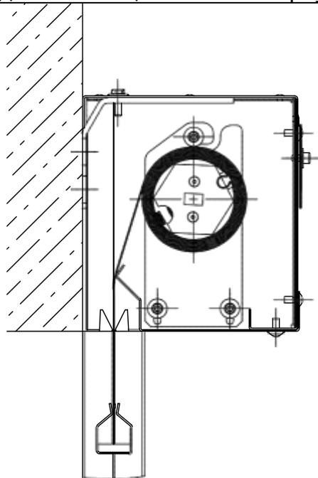
Затем производится монтаж направляющей полотна, крепление осуществляется винтами М5 или М6.
